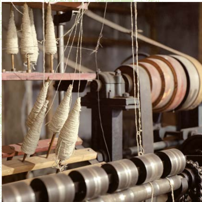
Beauvezer (04), détail d'une retordeuse d'une draperie
